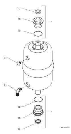
Figure 40: Maintenance-Free Actuator
